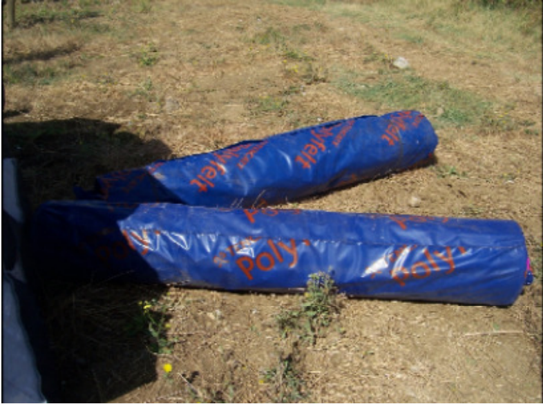
Figura 4 – Pezze di geotessile del tipo tessuto non tessuto (TNT) utilizzate per rivestire i sacchi drenanti IDROSAC 500 presso la tenuta in Montalcino
